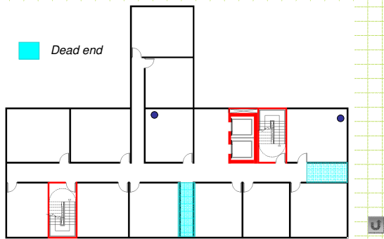
Pasadizo ciego, Pasillo muerto ( Dead end )
